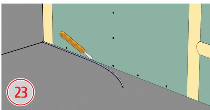
Віброізоляційну стрічку, яка виступатиме по периметру конструкції, зрізати канцелярським ножом під кутом близько 30°.
