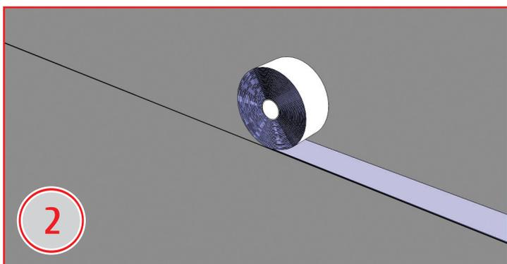
По розмітці обклеїти периметр майбутньої конструкції віброізоляційною стрічкою.
