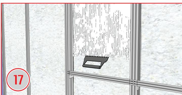
Після того, як вже приклеєний весь перший шар A4Sound Wall25. Нанести поверх першого шару зубчастим шпателем (гребінка – 3мм х 3мм) клей A4Sound GP та зверху приклеїти другий шар матеріалу A4Sound Wall25. Матеріал повинен також заходити в порожнину профілю.
