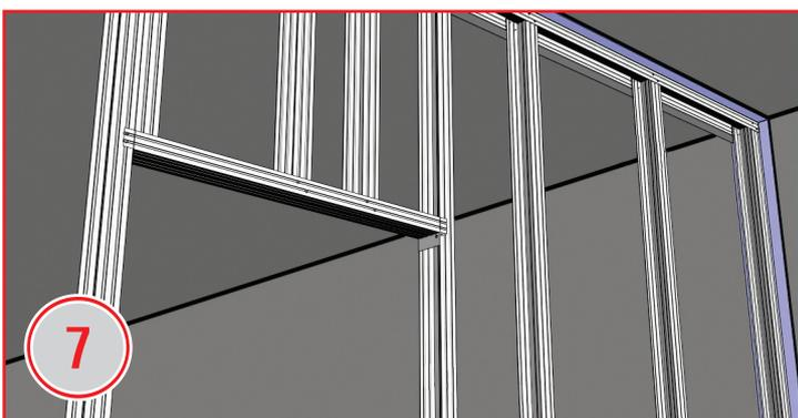
Якщо в перегородці планується дверний отвір, то змонтувати стійкові профілю на відстані, на якій буде дверний отвір.
