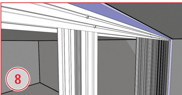
Вирівняти профілю по вертикалі та зафіксувати стоєчні профілі в направляючих за допомогою саморізів (3,5мм x 9мм).
