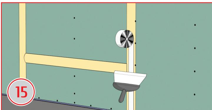
Стики другого шару ГКЛ також потрібно прогрунтувати та заповнити шпаклівкою з використанням серпанки або склополотна.
