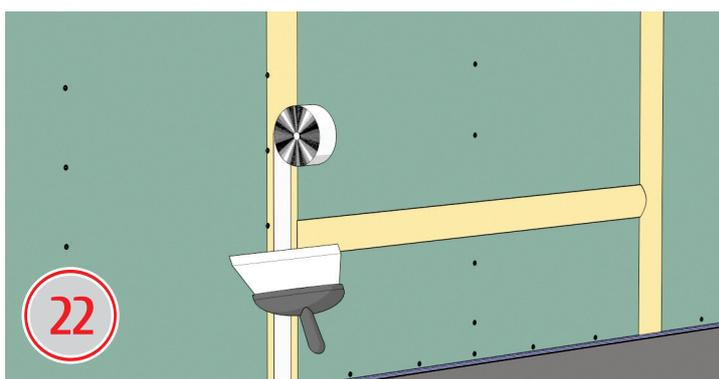
Стики другого шару ГКЛ також потрібно прогрунтувати та заповнити шпаклівкою з використанням серпianки або склополотна.
