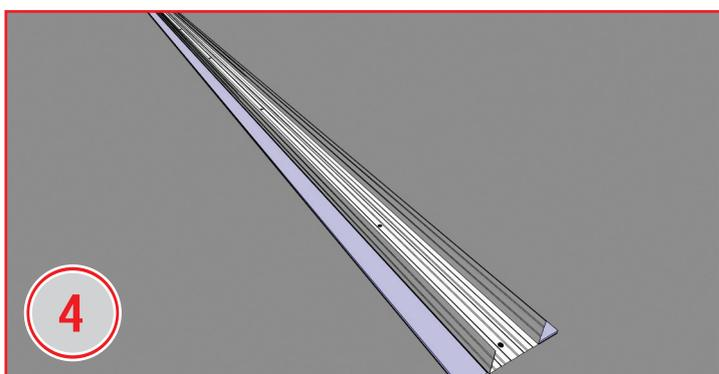
Встановити по розмітці на стелю та підлогу (поверх віброізоляційної стрічки) направляючий профіль UW50. Пробурити отвори діаметром 6мм через направляючий профіль в перекриття (відстань між отворами не більше 600мм) на глибину 50мм.
