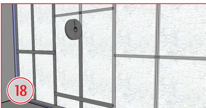
Обклеїти віброізоляційною войлочною стрічкою A4Sound напрямні, стійкові профілю та перемички.
