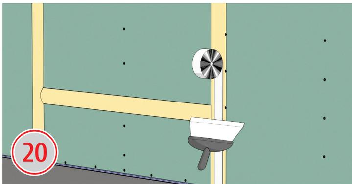
Стики ГКЛ потрібно прогрунтувати та заповнити шпаклівкою з використанням серпianки або склополотна.
