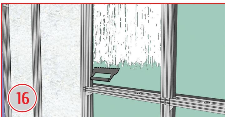
З внутрішньої сторони конструкції на ГКЛ нанести зубчастим шпателем (гребінка – 3мм х 3мм) клей A4Sound GP та зверху приклеїти перший шар матеріалу A4Sound Wall25. Матеріал повинен заходити у порожнину профілю.
