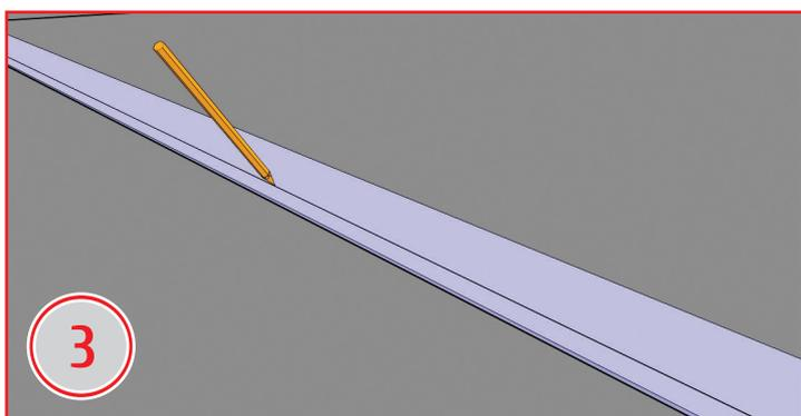
На віброізоляційну стрічку нанести розмітку для установки напрямного профілю.
