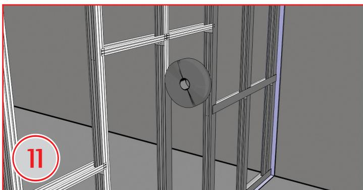
Обклеїти віброізоляційною войлочною стрічкою A4Sound напрямні, стійкові профілю та перемички з одного боку конструкції.
