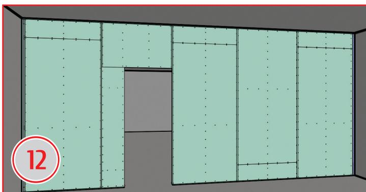
Після того як каркас із профілю готовий. Встановити з одного боку конструкції перший шар ГКЛ і прикрутити саморізами (3,5мм x 35мм).
