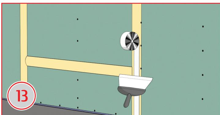
Стики ГКЛ потрібно прогрунтувати та заповнити шпаклівкою з використанням серп'янки або склополотна.
